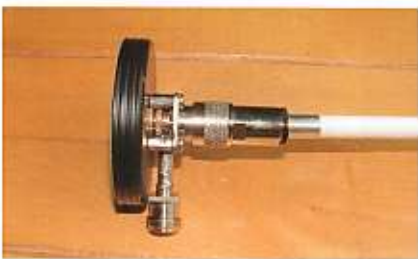
De magneetvoet bijna gereed. Hier is de aluminium schijf nog niet gemonteerd.
